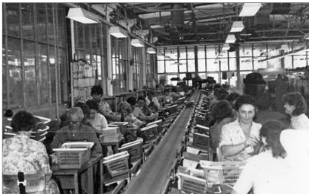
il. 3 Fragment szwalni w Fabryce Obuwia numer 3 w Solcu Kujawskim. W części centralnej widoczny pas transmisyjny, druga połowa lat siedemdziesiątych (źródło: zbiory Muzeum Solca im. Księcia Przemysła, numer inwentarzowy MS/H/F/481/2)
